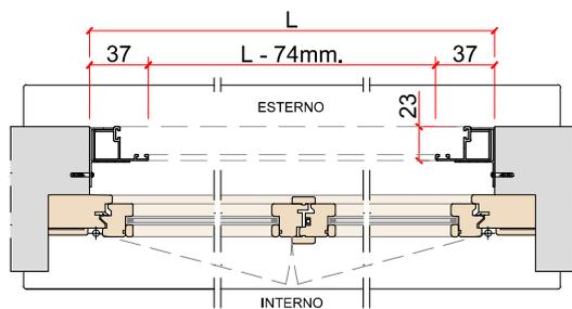
Applicazione standard vano con cuffia e telaio
