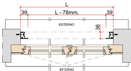
Applicazione standard vano con profilo compensatore e telaio
