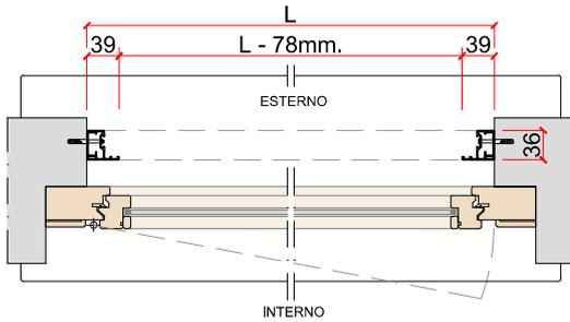
Applicazione standard vano con profilo compensatore e telaio
