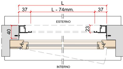
Applicazione standard vano con cuffia e telaio
